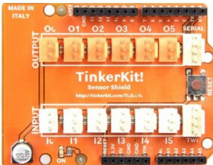
Ce shield dispose de 12 connecteurs TinkerKit 3 broches standard. Les 6 libellés **I0 à I5** sont des **entrées analogiques**. Ceux étiquetés **O0 à O5** sont des **sorties analogiques** connectées aux sorties PWM de la carte (il est possible de les configurer en entrées numériques).
