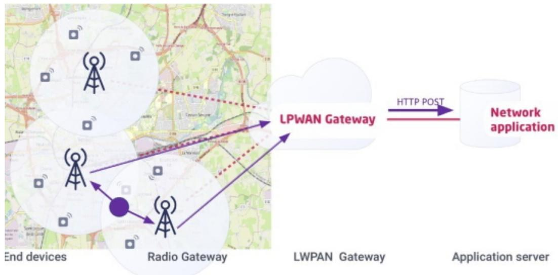
L'appareil envoie des données brutes sur le réseau radio. Le signal radio est capté par une ou plusieurs passerelles radio, et la trame est envoyée à une passerelle réseau (LNS - LoRa Network Server- pour les réseaux LoRaWAN, et SCEF - Service Capability Exposure Function Gateway - pour les réseaux 3GPP).
