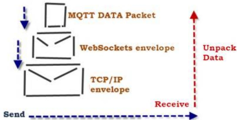
La **version 1.5.7** du **broker Mosquitto** pour Raspberry Pi OS est **compatible avec les Websockets**. Il faut configurer le fichier `mosquitto.conf` pour que la communication s'établisse entre le broker et un client.
