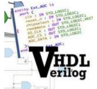
Contrairement à un microprocesseur, **un circuit logique programmable n'exécute aucune ligne de code**. Un code de programmation est cependant nécessaire pour **assembler les opérateurs logiques** qui le composent.
