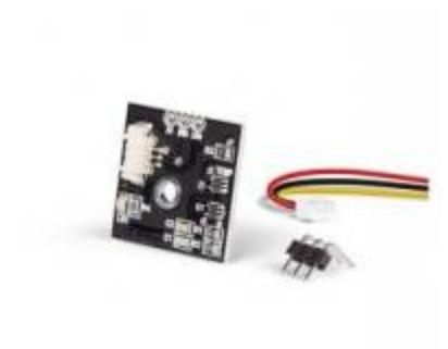
Capteur de température Velleman basé sur un amplificateur **MCP6L01T-E / LT** permettant de mesurer la **température** entre -50 et 150 °C. Il communique avec un microcontrôleur type Arduino ou compatible via une liaison analogique.
