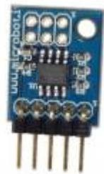
Capteur de température Microbot basé sur un TCN75A et permettant de mesurer une température entre -40 et +125 °C. Il communique avec un microcontrôleur via le bus I2C.
