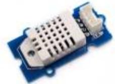
Le module Grove DHT22 de Seeed Studio est basé sur un module numérique de mesure de la température et de l'humidité AM2302 de AOSONG. Les détails internes du module ne sont pas connus, mais la documentation, accessible ci-dessous, nous apprend qu'il se compose :
