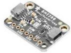
Capteur environnemental mesurant la **température, la pression barométrique et l'humidité** ! Ce capteur est idéal pour toutes sortes de capteurs météorologiques / environnementaux et peut être utilisé à la fois en **I<sup>2</sup>C** et en SPI.
