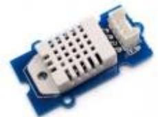
Ce capteur de température et d'humidité (version pro DHT22) compatible Grove utilise une thermistance CTN et un capteur capacitif et délivre une sortie digitale.
