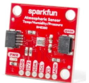
Capteur environnemental mesurant la **température, la pression barométrique et l'humidité** ! Ce capteur est idéal pour toutes sortes de capteurs météorologiques / environnementaux et peut être utilisé à la fois en **I<sup>2</sup>C** et en SPI.
