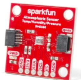
Capteur environnemental mesurant la **température, la pression barométrique et l'humidité** ! Ce capteur est idéal pour toutes sortes de capteurs météorologiques / environnementaux et peut être utilisé à la fois en **I<sup>2</sup>C** et en SPI.
