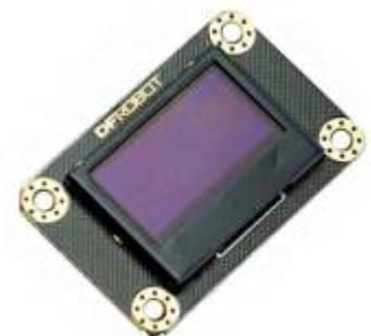
Un écran **OLED** fonctionne sans rétroéclairage. Ainsi, il peut afficher des niveaux de **noir profond** et peut être plus mince et plus léger qu'un écran à cristaux liquides (LCD). Dans des conditions de **faible luminosité ambiante**, telles qu'une pièce sombre, un écran OLED peut obtenir un taux de contraste plus élevé qu'un écran LCD.
