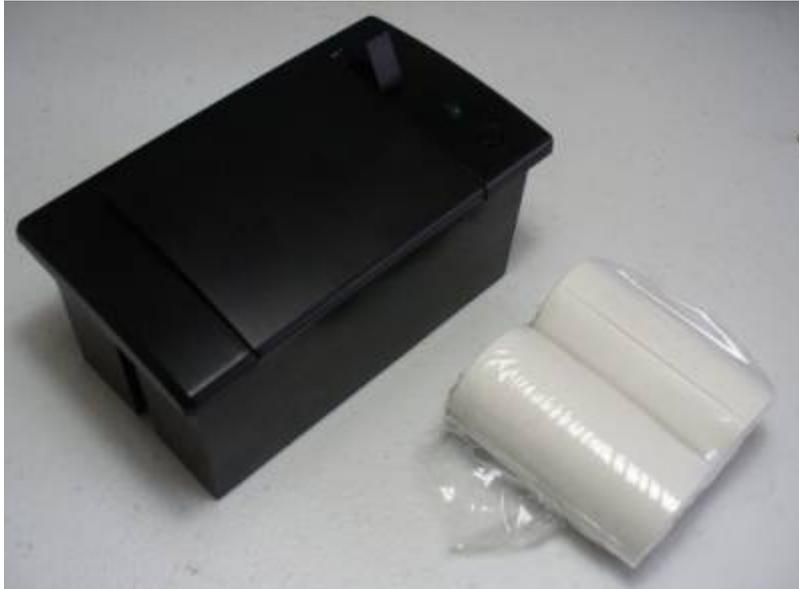
Le chargement du papier est assez simple, il suffit de déposer le rouleau avec le bout du papier face à vous, de le tirer plus loin que le haut de la lèvre avant, puis de refermer le couvercle.
