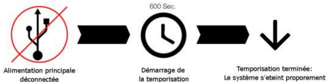
Dans la console du StromPi 3, la temporisation est réglable via la ligne de commande suivante :
