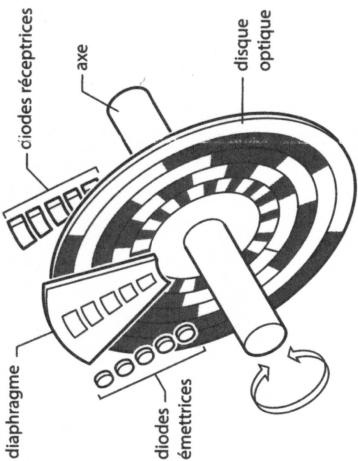
Dans le cas d'un capteur optique, le disque, solidaire de l'axe, comporte des motifs : segments opaques et segments transparents. D'un côté du disque, des diodes émettent de la lumière, celle-ci passe à travers les segments transparents et est bloquée par les segments opaques. De l'autre côté du disque, les diodes réceptrices reçoivent ou non la lumière.
