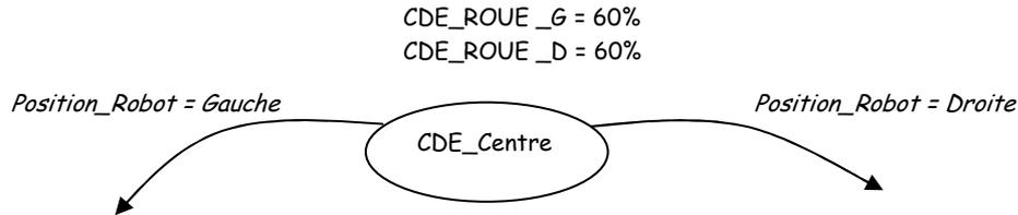
Dans l'exemple ci-dessus, si le robot se trouve au centre de la ligne, chaque roue est commandée avec 60% de la tension d'alimentation. Si le robot détecte que sa position est à gauche ou à droite de la ligne, il changera d'état (voir le graphe des transitions dans le
