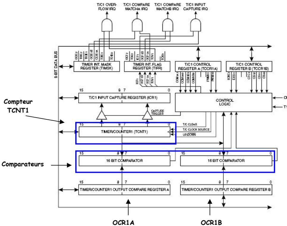
Le compteur TCNT1 génère le signal numérique M. Les registres OCR1A et OCR1B correspondent à N. Les broches du composant OC1A et OC1B correspondent à S. Le Timer 1 contient donc deux structures dont le fonctionnement répond au principe exposé dans le paragraphe précédent.
