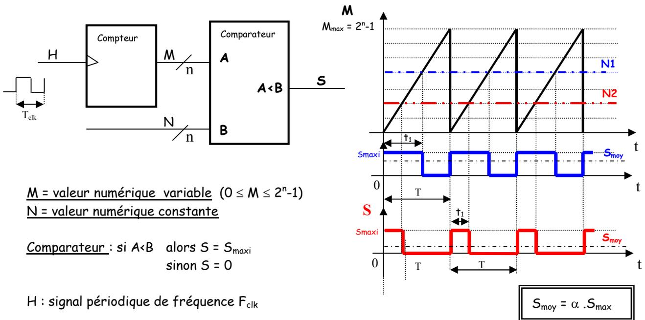
Dans les microcontrôleurs, les signaux modulés en largeur d'impulsion sont générés par une structure appelée **TIMER**. Celle-ci répond au principe développé ci-dessus.
