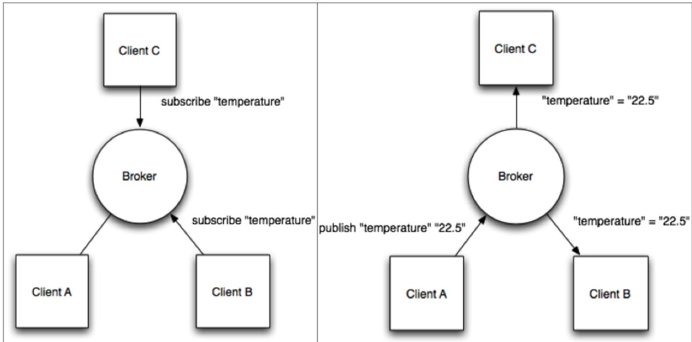
Les trois clients établissent une connexion TCP avec le broker. Les clients B et C souscrivent au topic temperature.
