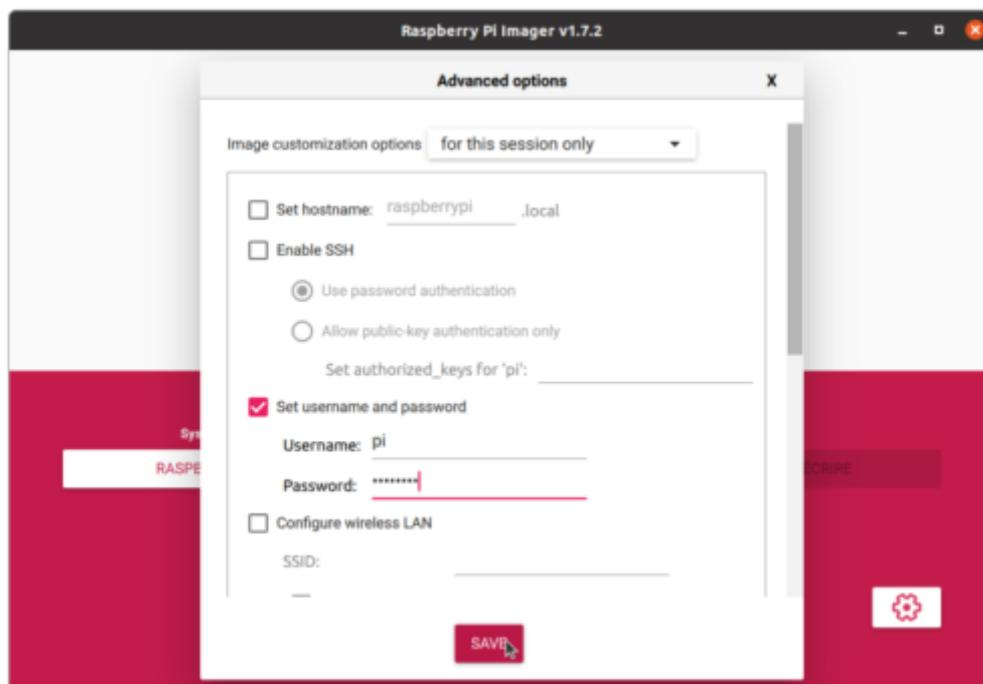
Télécharger l'application **Raspberry Pi imageur** qui convient à votre environnement : Windows, macOS ou Linux (Ubuntu uniquement) et l'installer sur le PC. En cliquant sur l'icône outil, on accède à la fenêtre des options avancées, laquelle permet de choisir d'activer ou non [un serveur SSH](#), de [configurer un réseau Wi-Fi](#), et de créer un compte utilisateur et un mot de passe par défaut.
