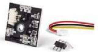
Capteur de température Velleman basé sur un amplificateur MCP6L01T-E / LT permettant de mesurer la température entre -50 et 150 °C. Il communique avec un microcontrôleur type Arduino ou compatible via une liaison analogique.
