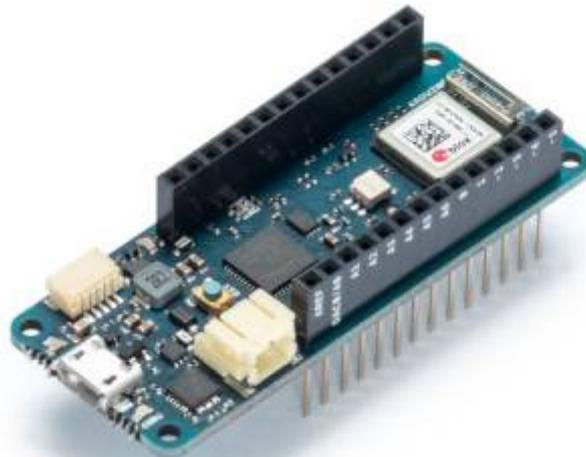
Le réseau Wi-Fi est à faible consommation d'énergie. Le port USB du MKR1010 peut être utilisé pour alimenter la carte sous 5V. Il possède un circuit de charge Li-Po qui permet à l'Arduino MKR WIFI 1010 de fonctionner sur batterie ou sur une source externe de 5 volts, chargeant la batterie Li-Po tout en utilisant une alimentation externe. Le passage d'une source à l'autre se fait automatiquement.
