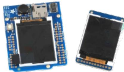
Pour fonctionner, l'afficheur LCD couleur **ST7735 1,8"**, monté sur un **shield v2** ou seul (**breakout**), nécessite l'installation des bibliothèques :
